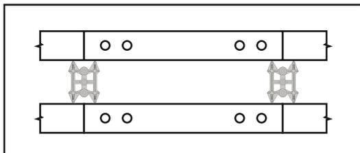
2. Cuando se instala manualmente se recomienda hacerlo con dos clavos, si se utiliza una herramienta de fijación accionada con gas, puede hacerse con un clavo solamente.
