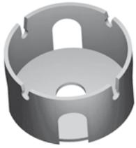
Silleta o separador vertical, fuerte y estable. Amplia base para utilizarse sobre superficies suaves o poco compactadas. Aplicaciones: Para armados de malla electro soldada en todo tipo de losas de concreto, principalmente en capas de compresión de 3 a 6 cm de espesor sobre casetón de poliestireno, bovedilla o losa de acero.
