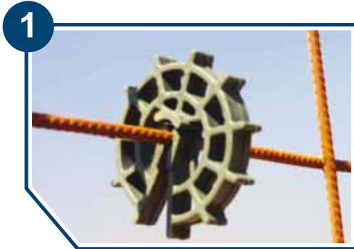
2. Es importante que los discos estén colocados correctamente cada 60 a 75 cm de distancia, traslapándose. Para separar columnas deberán colocarse simultáneamente en caras opuestas, alternando en las cuatro caras del armado. En columnas circulares se distribuyen los discos por hiladas a través del diámetro total del armado.
